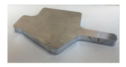
RSP铝合金的微晶结构使其可以应用在空间观测设备上。在空间的低温环境下,铝合金反射镜与其安装的 支撑结构的金属材料的膨胀系数接近。,降低其膨胀系数不匹配的影响,可以避免了光机系统材料膨胀系数不 一致带来的热应力和应变。保证其光学系统参数长期稳定在一个范围值内[RSP铝合金可以用现有的车,磨,铣 等工艺快速制作加工反射镜基本结构,充分发挥铝合金材料易成型的特点。同时可以用单点金刚石车削工艺加工反射镜镜面。可以直接获得满足光学系统成像质量高的光滑表面[RSP铝合金的抗疲劳性好,在航空航天材料应用中有良好的性价比[RSP铝合金热稳定性和机械稳定性高,可以应用在高精密工业半导体部件上。高伸长率的微晶铝合金。微晶铝合金电子
