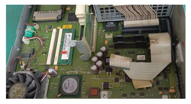
工业电路板损坏通常是某一个元件损坏,如某一个芯片,某一个电容,甚至一个小小的电阻,维修的过程就是找出损坏的元件加以更换。维修工业电路板上的元器件这些细节需要注意:1、阻值小的电阻和容量大的电容易坏。阻值小的电阻常用于供电线路上起限流的作用,也就是起保险丝的作用;若电流过大,会把其烧断。另外,供电线路上用许多对地电容来滤波,若电压或电流不稳定就会击穿电容而导致漏电。2、电容损坏的故障特点及维修,电容损坏引发的故障在电子设备中是比较高的,具体表现为:容量变小;完全失去容量;漏电;短路。3、运算放大器的好坏判别方法,不论是何种类型的放大器,都有一个反馈电阻Rf,我们在维修时可从电路上检查这个反馈电阻,用万用表检查输出端和反向输入端之间的阻值。根据放大器虚短的原理,如果运算放大器工作正常的话,其同向输入端和反向输入端电压必然相等!4、学会在缺少相关资料情况下,给工业设备进行维修。
